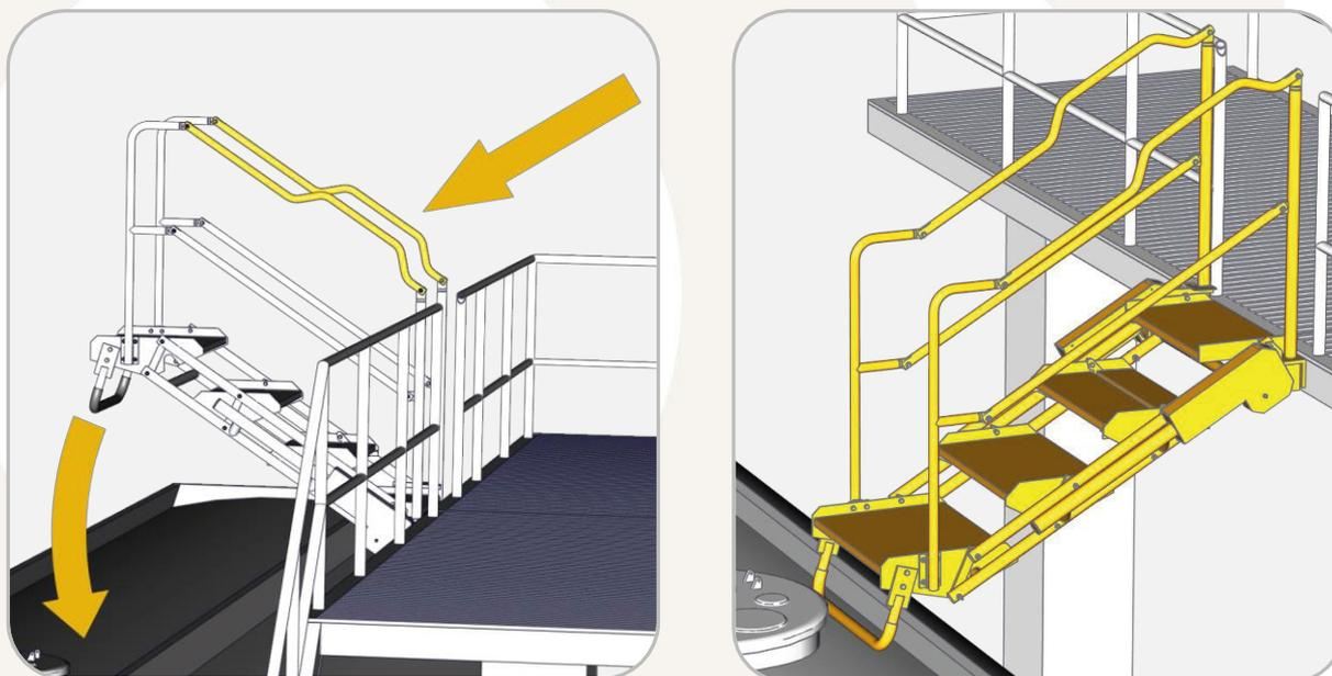
Figura 6 - Aclonamento da Escada
