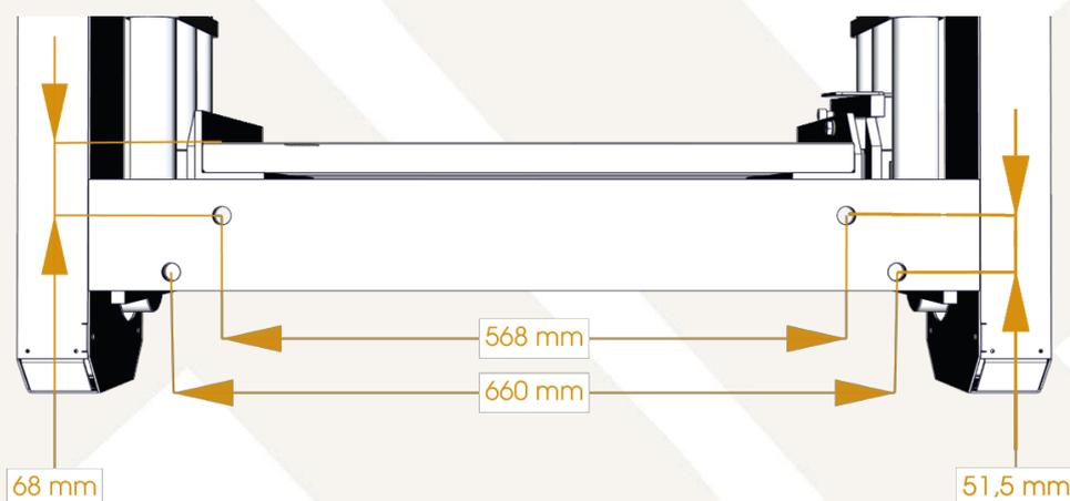
Figura 1 fi Medidas de Furação de Fixação da Escada
