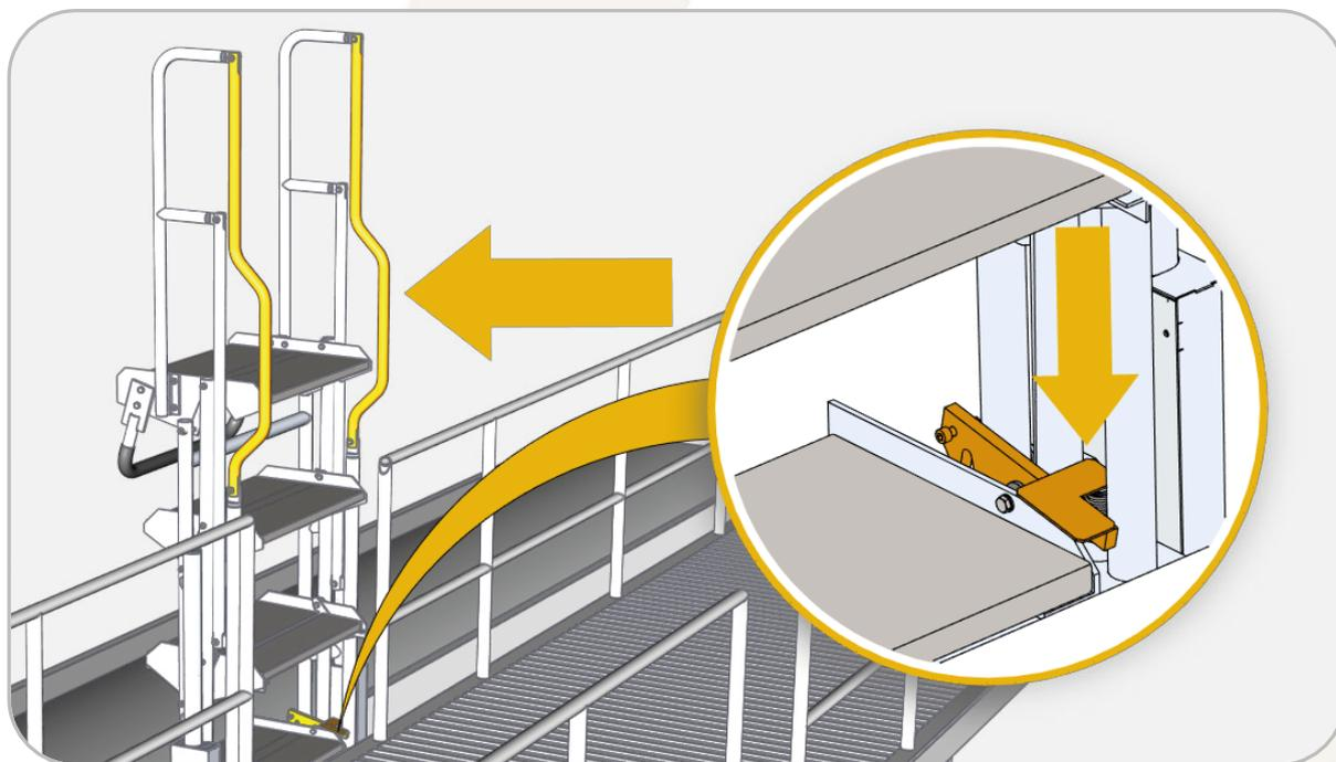
Figura 5 - Pedal de Destravamento/Travamento
