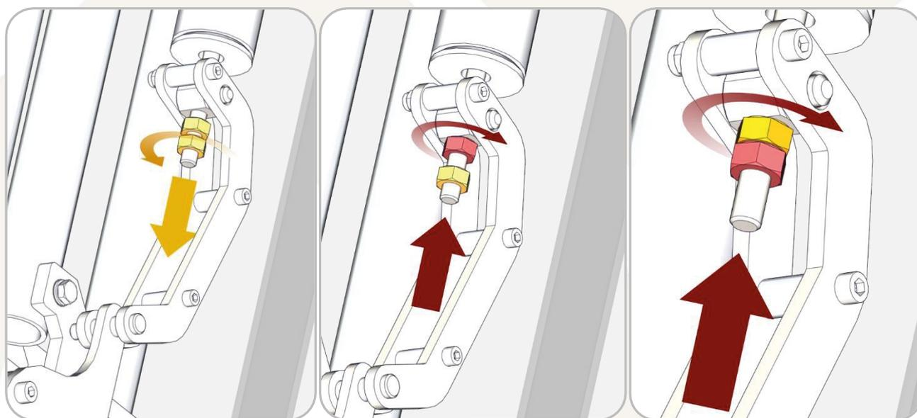
Figura 10 - Ajuste de Força das Molas
