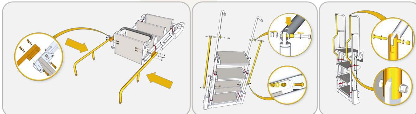
Figura 2 fi Montando peças soltas (Corrimões e Guarda-corpo)
