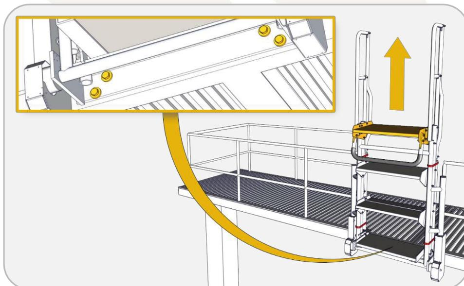
Figura 4- Fixação da Escada
